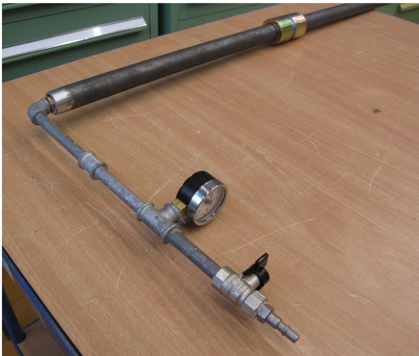
Bild 3: Pneumatikanschluss mit Manometer und Absperrhahn für Dichtheitsprüfung
